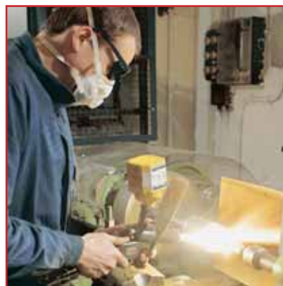
rechts: Welle richten unten: Lagerpassitz aufspritzen
